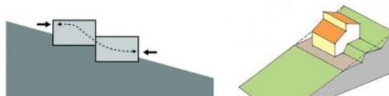
Schéma d'une implantation en cascade
