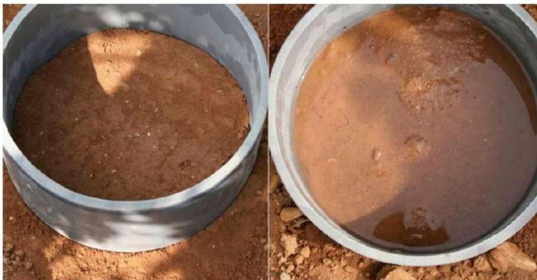
*Photo d'un test Beerkan : à gauche un sol non tassé et à droite un sol tassé*
