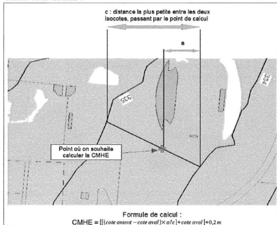
Exemple de calcul : a= 100m ; c=300m ; cote amont : 335 ; cote aval : 334
