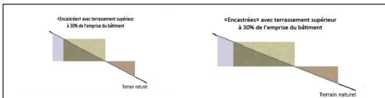
L'équilibre déblais/ remblais doit être recherché et les murs de soutènement doivent être limités au maximum pour réduire l'impact visuel sur le site.
