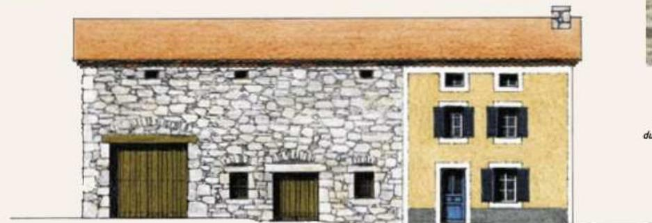
La façade dégradée de cette ferme a été renouvelée par une reconstitution en surface du pisé. Cette technique permet de conserver l'aspect originel de la construction.
