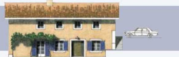
L'implantation perpendiculaire aux courbes de niveaux, la large toiture deux pans s'inspirent des constructions traditionnelles du Livradois. Les avancées de toit protègent l'entrée ainsi qu'une terrasse ouverte sur la vallée. La structure bois est posée sur un soubassement en pierre.
