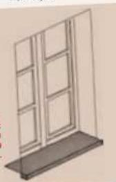
*L'appui peut être réalisé en zinc ou en aluminium laqué qui reprendra la teinte de l'encadrement de fenêtre.*
